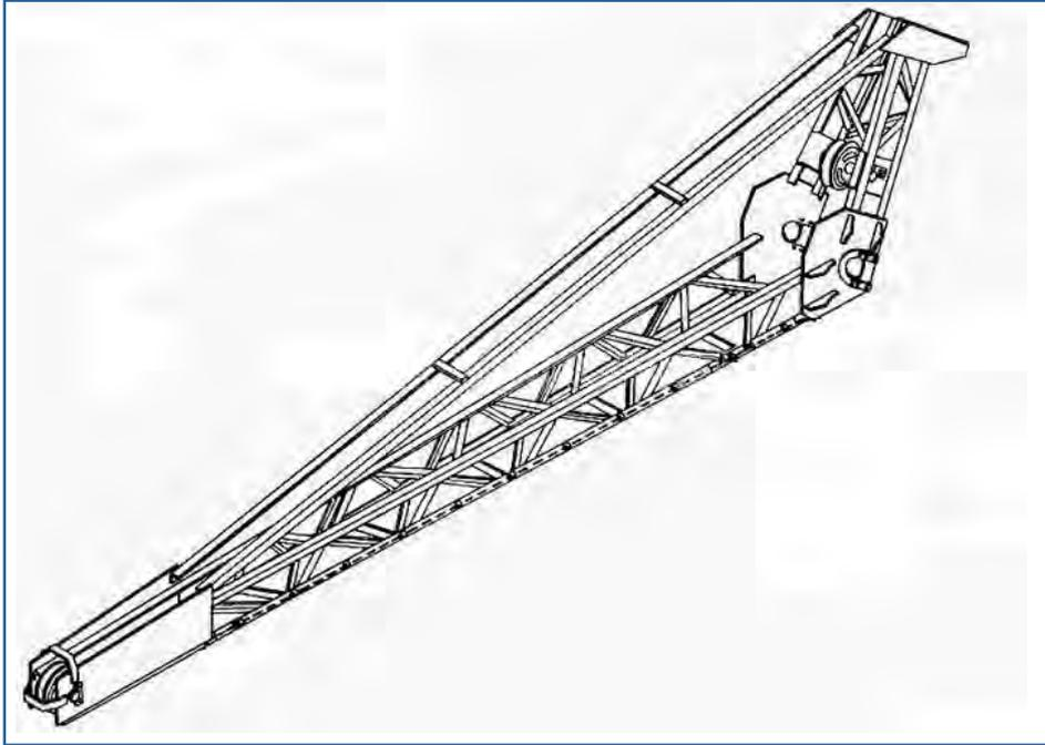
Гусек (решетчатый удлинитель стрелы) представляет собой сварную металлоконструкцию предназначенную для удлинения стрелы.
