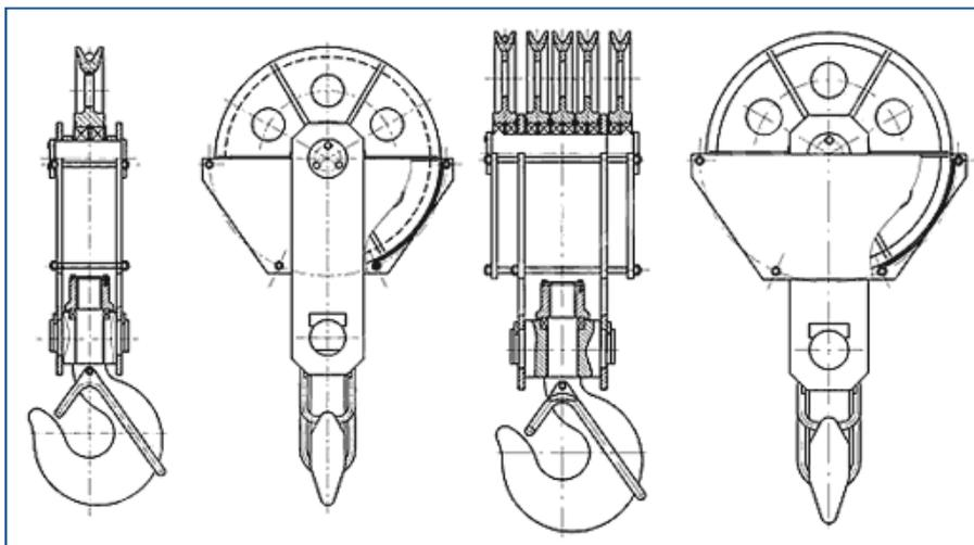
На грузовом канате грузовой лебёдки крепится дополнительная крюковая подвеска.
