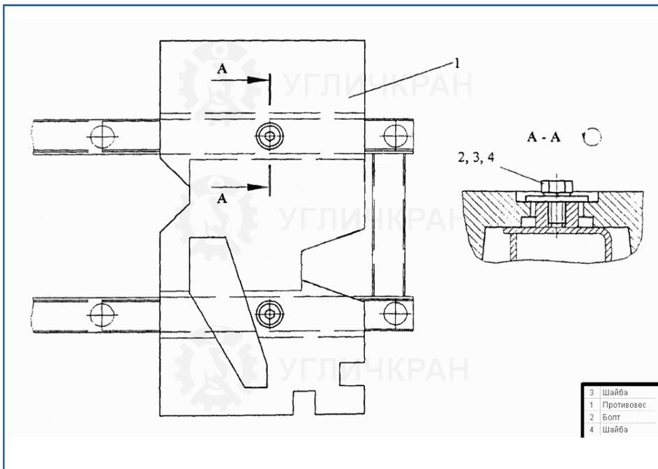
Использование при работе дополнительного съемного отдельно возимого противовеса позволяет значительно поднять грузовые характеристики крана на средних и дальних вылетах, а также обеспечить максимальный рабочий вылет стрелы.
