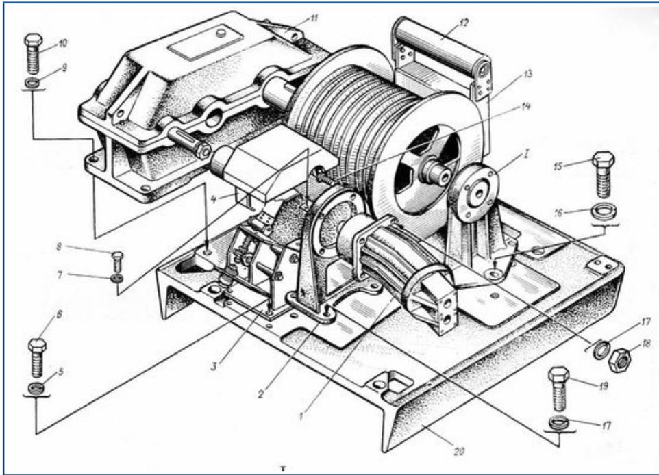
Грузовая лебедка автокрана является приводным устройством для подъема и опускания груза установленной на конце поворотной платформы.
